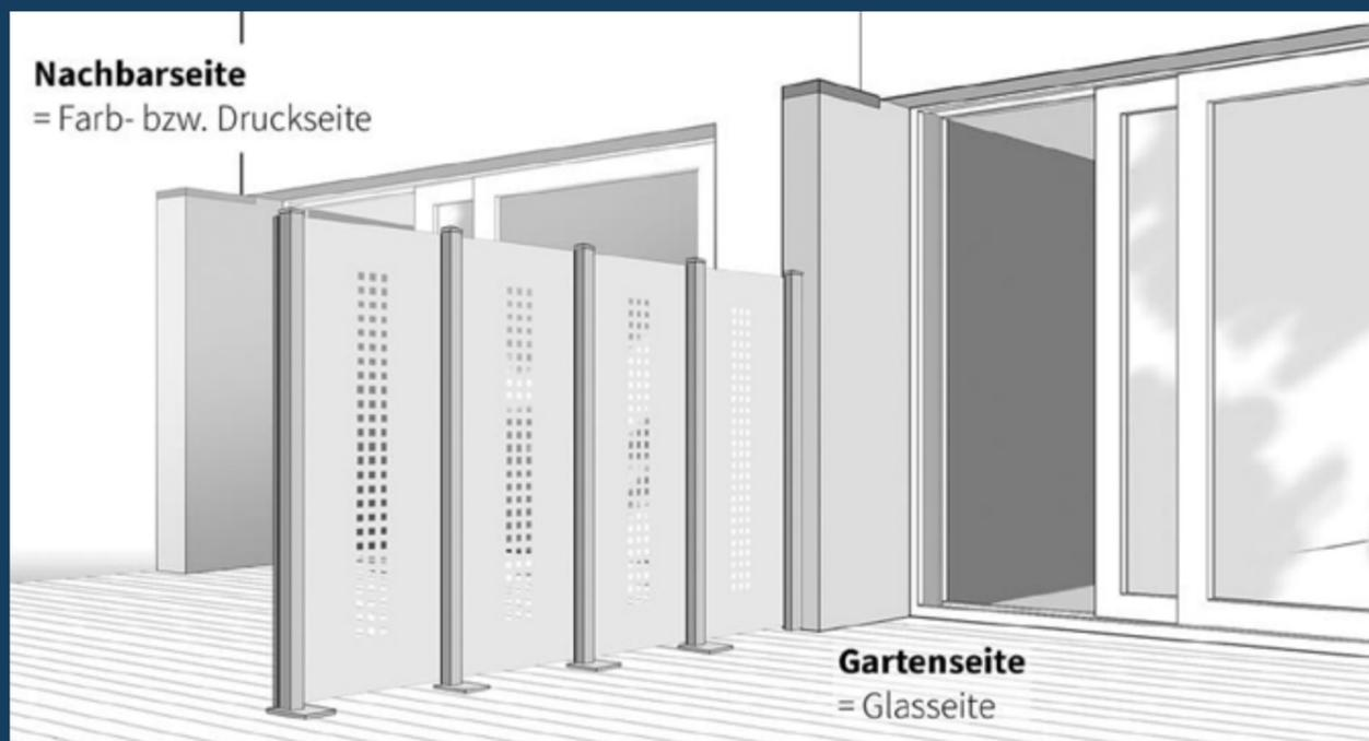
Bedruckte Glaselemente haben eine Farb- und eine Glasseite. Auf der Farbseite werden die keramischen Kolorierungen gedruckt und eingebrannt. Diese Farbseite zeigt bei einem Sicht- und Windschutz zum Nachbargrundstück und wird Nachbarseite genannt. Die nicht bedruckte Glasseite zeigt zu Ihrem Grundstück, der sogenannten Gartenseite, hin. Diese Angabe ist für alle Glasschrägschnitte notwendig.
